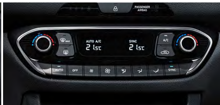
Dwustrefowa klimatyzacja automatyczna z systemem automatycznego odparowywania
